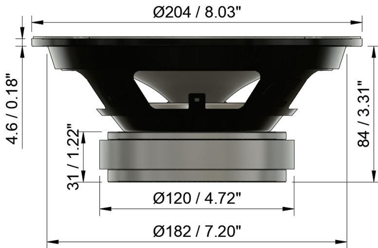
Lochkreisdurchmesser / Bolt circle diameter: Ø195 / 7.68" (4x Ø5 / 0.20")
