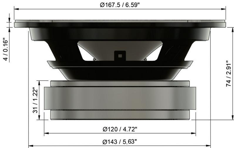
Lochkreisdurchmesser / Bolt circle diameter: Ø157 / 6.18" (4x Ø5.5 / 0.21")
