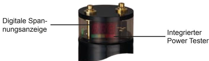
Der Power Tester hilft Ihnen dabei Spannungsschwankungen direkt zu erkennen. Ist die Spannung stabil, leuchten alle LEDs. Kommt es zu Spannungsschwankungen, erlöschen die LEDs von grün nach rot.
