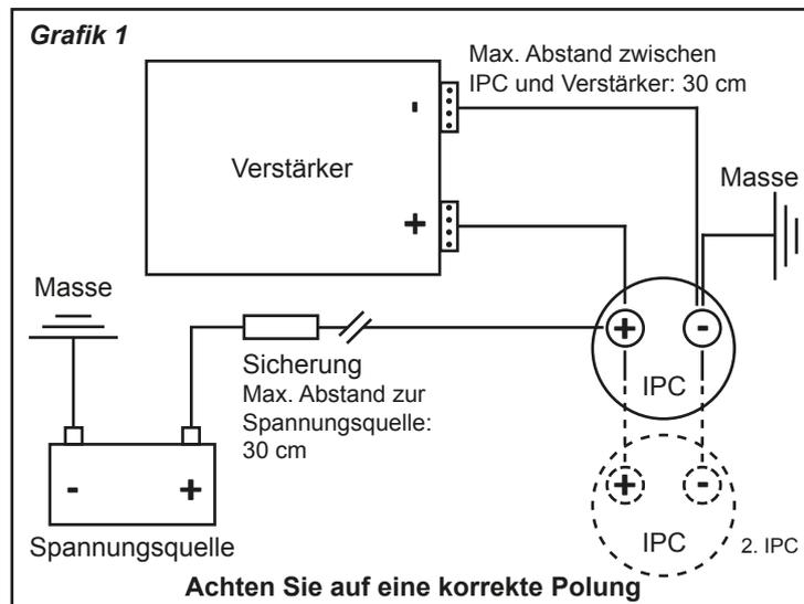
**Hinweis:** Sollte ihre Anlage mehr Kapazitäten benötigen, können Sie mehrere IPCs parallel anschließen. Dazu verbinden Sie zuerst alle Pluspole (+) der Kondensatoren und anschließend auf die gleiche Weise alle Minuspole (-) (siehe Grafik 1).
