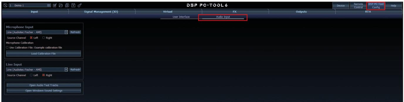
3. Stellen Sie sicher, dass in den Bereichen „Microphone Input“ und „Line Input“ jeweils „Audiotec Fischer – AMI“ als Eingabegerät ausgewählt ist.
